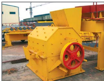
Sản xuất thành công máy nghiền búa Model NBHP-1.2x1.6
